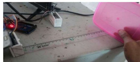
Gambar 11. Uji coba Jarak Sensor HC-SR04
