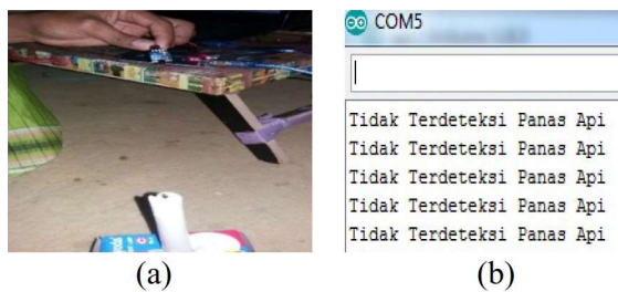
Gambar 12.(a) Uji coba sensor api tanpa api, (b) Tampilan sensor api di Arduino IDE
