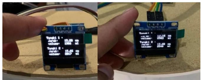
Gambar 10. Tampilan Jarak Permukaan Cairan pada Tangki yang Terbaca oleh Sensor Ultrasonik
