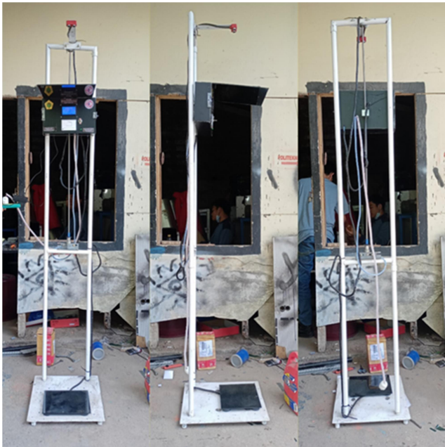
Gambar 5. Mekanik Alat Pengukur IMT tampak depan, samping dan belakang
