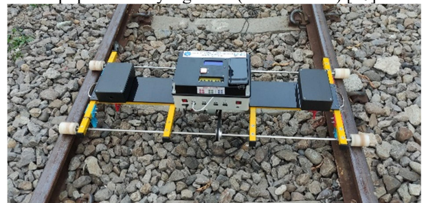
Gambar 9. Pengujian Dinamis di Rel Kereta Api
