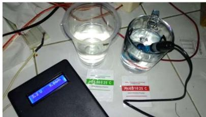
Gambar 3.4. Foto Pengujian pH Sehingga mendapatkan tegangannya untuk mencari pH step menggunakan Rumus.
