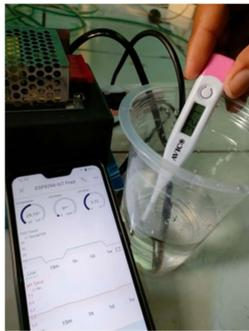
Gambar 3.1 pengujian sensor suhu DS18B20
