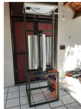
Gambar 3.7. Pembangkit Hybrid PV dan turbin angin type savonius untuk penerangan lampu jalan tol
