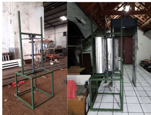
Gambar 3.4. Hasil Kerangka dan Blade Turbin Angin Type Savonius
