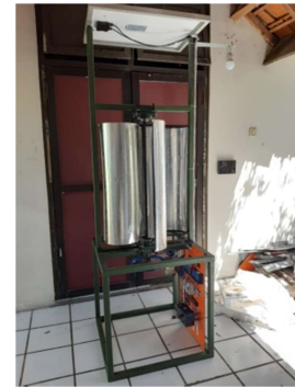
Gambar 3.7. Pembangkit Hybrid PV dan turbin angin type savonius untuk penerangan lampu jalan tol
