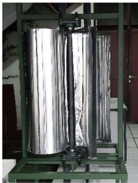
Gambar 3.6. Turbin angin type savonius untuk pembangkit listrik tenaga angin
