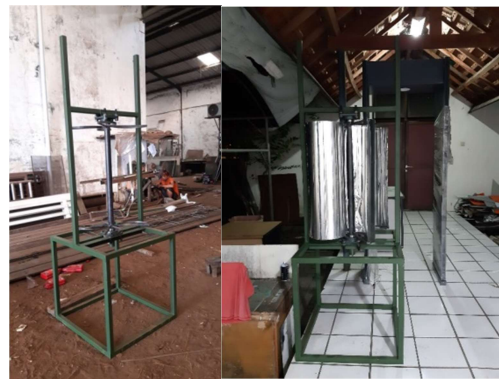
Gambar 3.4. Hasil Kerangka dan Blade Turbin Angin Type Savonius
