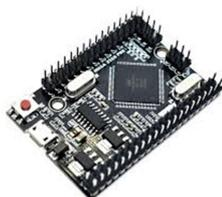
Gambar 1. Arduino mega 2560 pro mini
