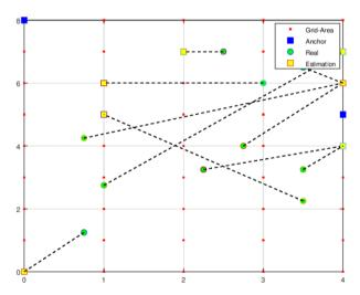
Gambar 4. Estimasi Posisi pada Area 5x9
