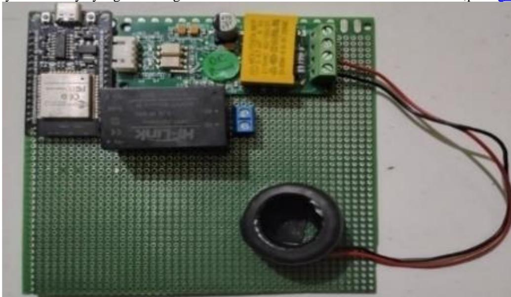
**Gambar 5.** Pemasangan Modul Hi-Link (220V AC ke 5V DC)
