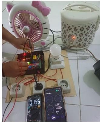
(a) uji arus rice cooker menggunakan multimeter
