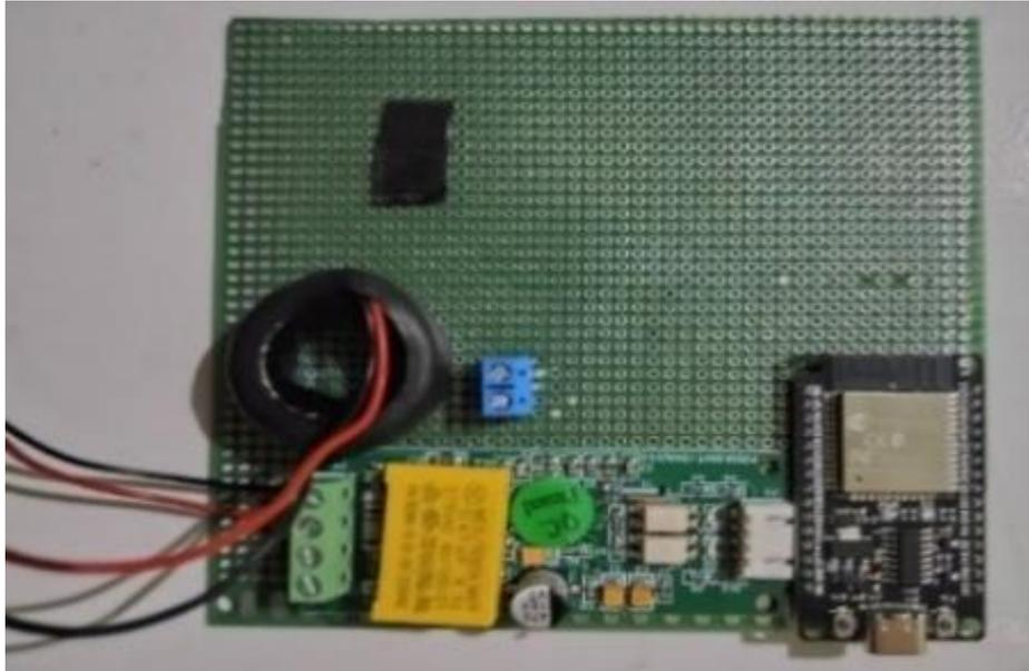
**Gambar 4.** Intehrasi mikrokontroler esp 32 dan sensor PZEM 004-T
