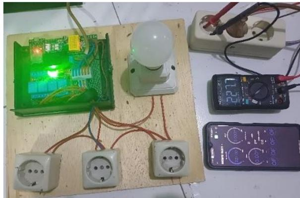
**Gambar 8.** Pengujian tanpa beban
