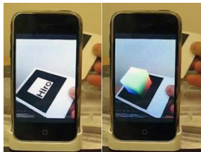
Gambar 3. Sistem berbasis layar untuk menampilkan AR
