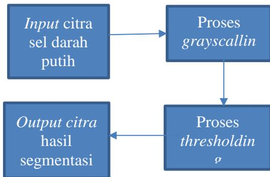
Gambar 4. Blok Diagram Proses Segmentasi
