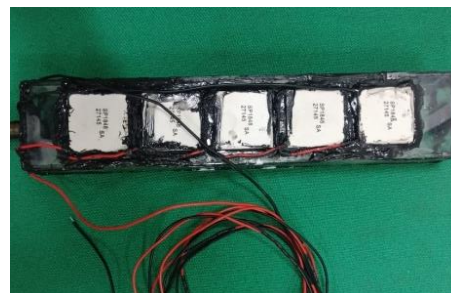
Gambar 2. Rangkaian seri dan paralel TEG127-40A
