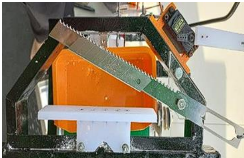
Gambar 8. Proses Servo (a) merupakan saat pisau tidak memotong; (b) saat pisau memotong.
