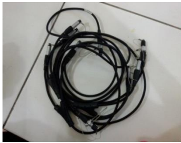
Kabel koneksi baterai
