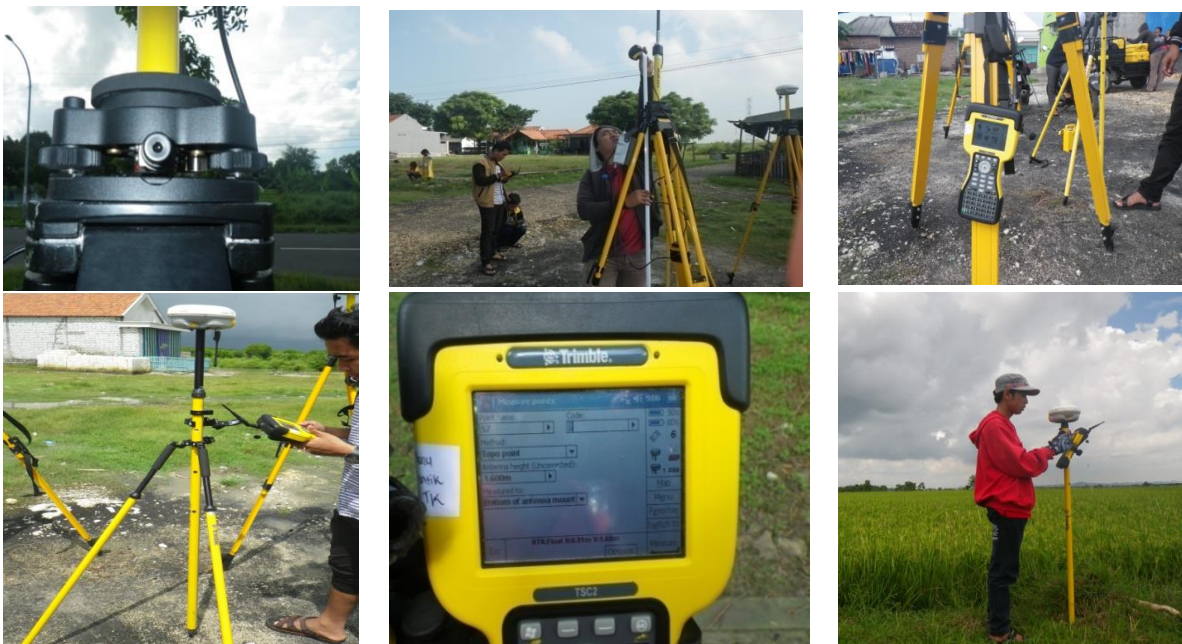
Gambar 5. Dokumentasi Survei Menggunakan GPS Geodetik R6
