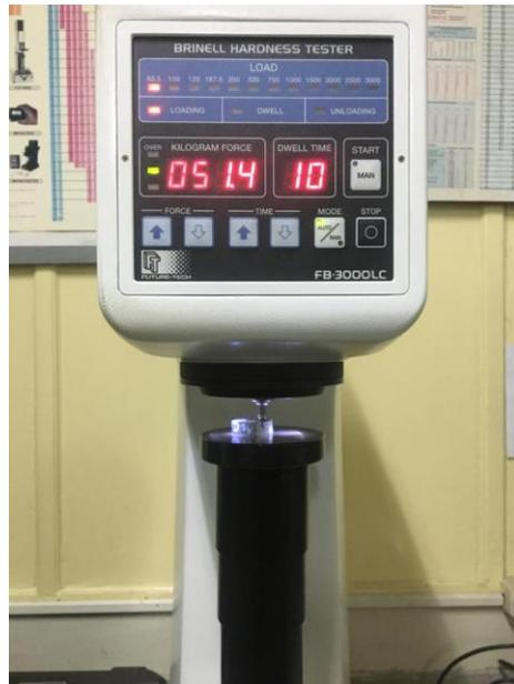
**Gambar 2.** Mesin Uji kekerasan *Brinell*
