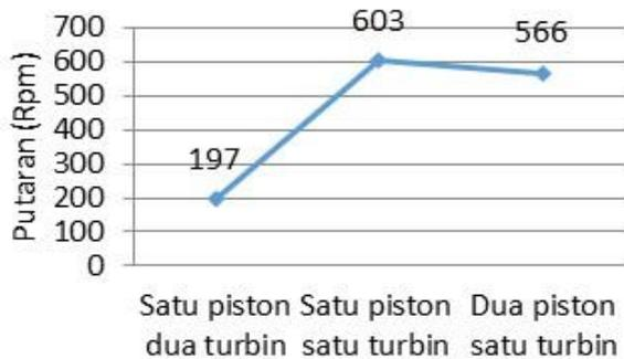
Gambar 3. Hasil Putaran Turbin pada Perbandingan Variasi Piston dan Turbin
