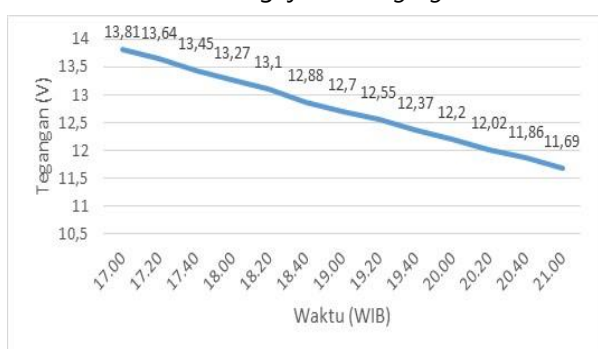
Gambar 11. Pengujian Discharging Baterai
