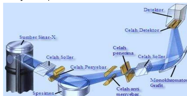
Gambar 1. Prinsip Kerja XRD (Jamaluddin, 2010)
