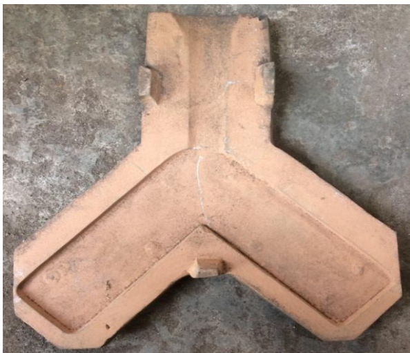
Gambar 3. Cetakan Die Casting untuk Spesimen Uji
