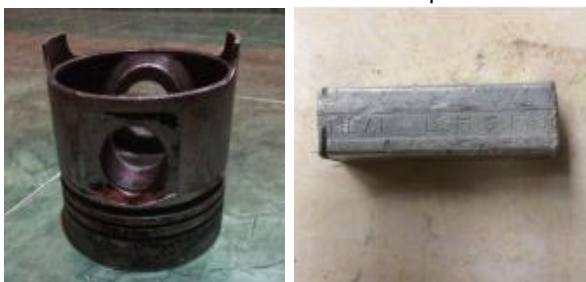
Gambar 4. (a) Piston bekas ( recycle ) untuk pembuatan specimen uji, (b) Unsur Titanium Boron (Ti-B) sebagai paduan pengecoran
