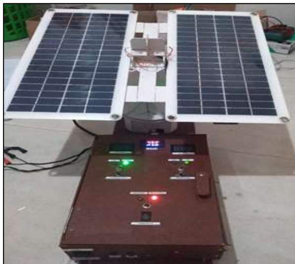
Gambar 5. Hasil desain solar tracker dua sumbu Tabel 1. Fungsi Komponen Sistem
