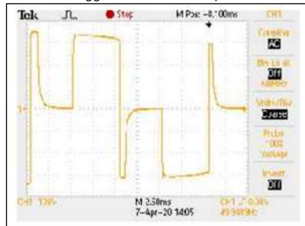
Gambar 12. Hasil Pengamatan Satu Periode Keluaran Inverter Square Wave Menggunakan Beban
