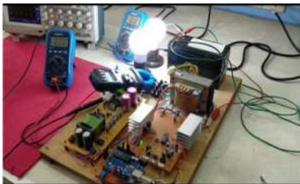
Gambar 5. Implementasi Inverter satu phasa
