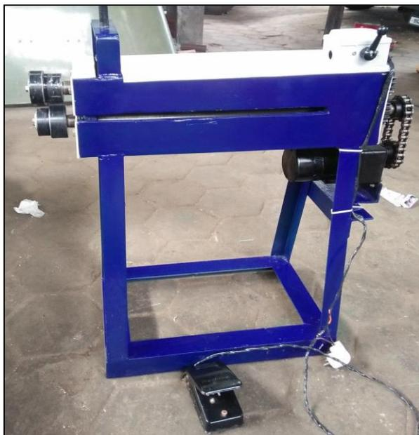
Gambar 7. Mesin *bead roller* dengan gigi *reducer*
