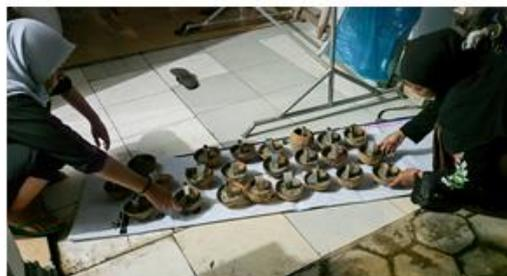
**Gambar 5. Hasil pengecoran substrat tempurung**
