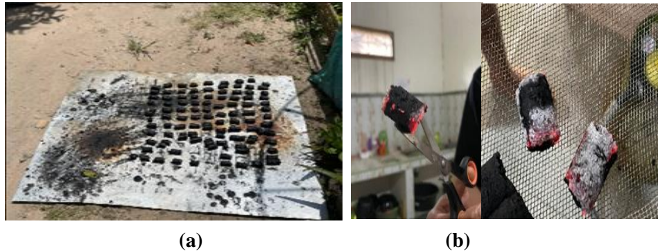
Gambar 5. (a) Proses Penjemuran Briket dan (b) Hasil Pembakaran Briket
