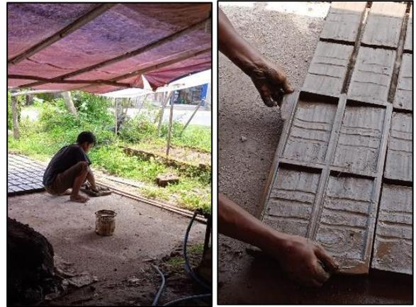
Gambar 3. Proses Pembuatan Bata Merah
