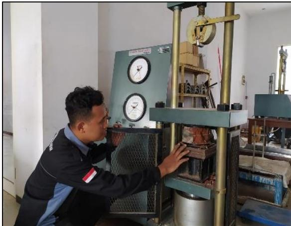
Gambar 5. Proses Pengujian Kuat Tekan Bata Merah
