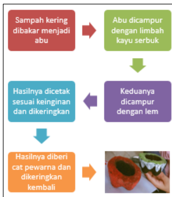
Gambar 3. Alur Pembuatan Kerajinan Tangan Asbak dari Bahan Dasar Sampah
