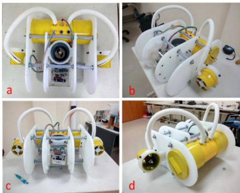
Gambar 13. Realisasi Perancangan Robot Jelajah Bawah Air
