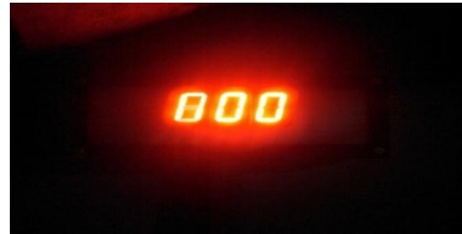
Gambar 8. Seven Segment Keadaan Hidup
