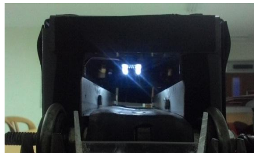
Gambar 9. Letak Sensor TC230
