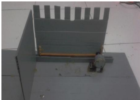
Gambar 7. Pintu Gerbang Yang Dikontrol Menggunakan Remote-Devices
