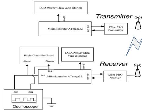
Gambar 10. Blok diagram pengujian pembangkitan sinyal PWM
