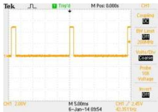
Gambar 14. Referensi input PWM pada PIN Elevator dan Aileron kondisi “Mundur” dan belok “Kanan”
