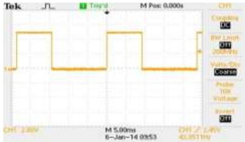
Gambar 12. Input PWM pada PIN Aileron dan Elevator
