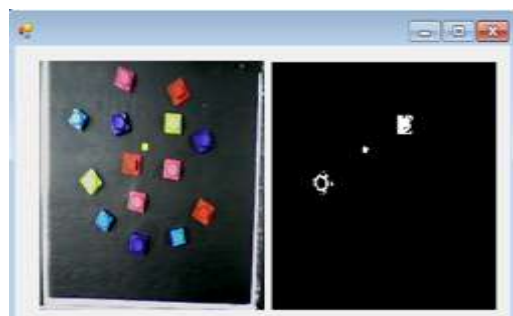
Gambar 11. Pengujian pengambilan titik tengah dua warna obyek.
