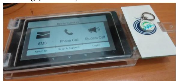
Gambar 5. Receptionist dengan casing dan extended antenna
