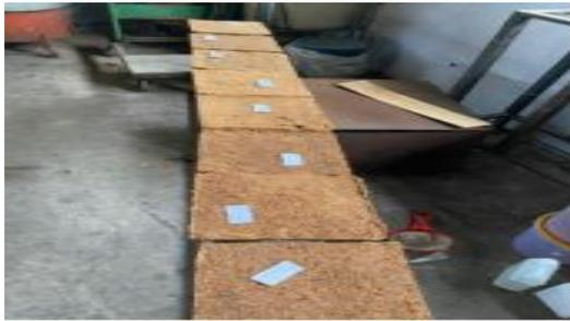
Gambar 2 Proses pengeringan papan partikel
