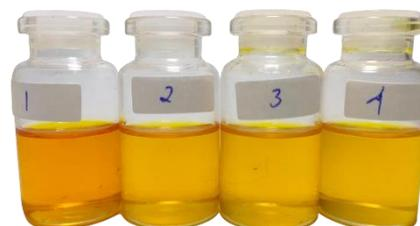
Gambar 1 Minyak jagung hasil pemurnian. (1) Minyak jagung mentah, (2) Minyak dimurnikan dengan zeolit, (3) Minyak dimurnikan dengan bentonit, dan (4) Minyak dimurnikan dengan karbon aktif
