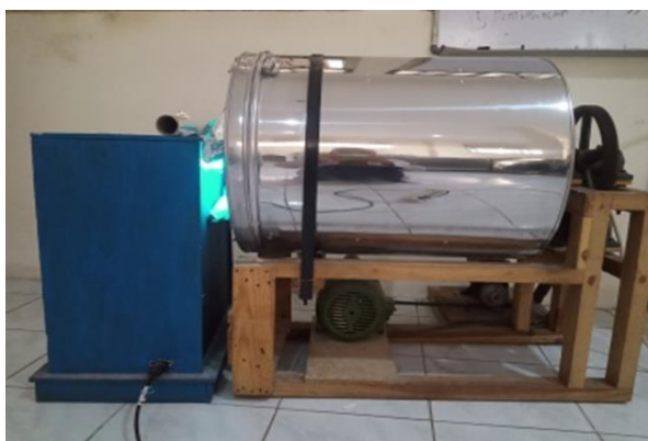
Gambar 1 Alat tumbler berputar iradiasi sinar UV-C
