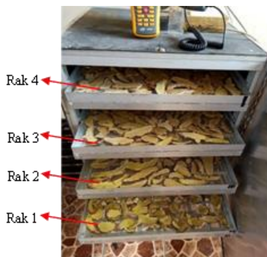
Gambar 3 Pengeringan Kunyit Putih di Dalam Ruang Pengereng
