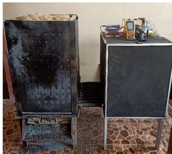
Gambar 2 Pengeringan Kunyit Putih pada Ruang Pengereng Tertutup Sistem Konveksi Paksa
