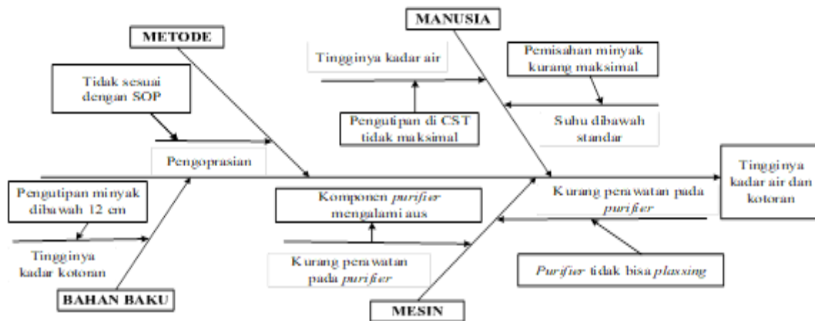
Gambar 2 Diagram sebab akibat tingginya kadar air dan kotoran pada mesin purifier
