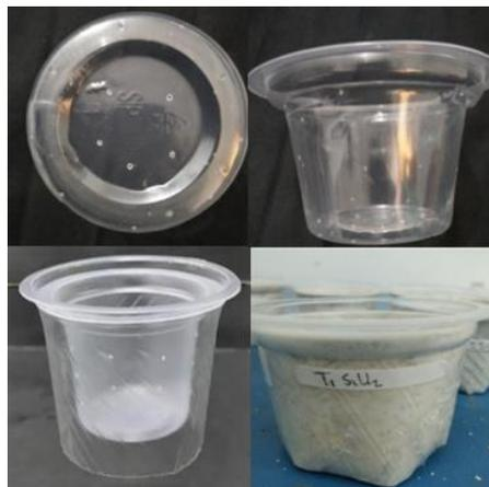
Gambar 1 Cetakan plastik *polypropylene* dalam pembuatan *biofoam cup*
