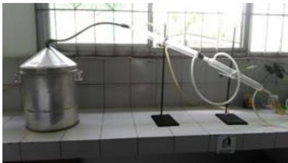
Gambar 1 Alat penyulingan (metode distilasi basah)
